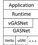
Fig. 1. Software stack of vGASNet
